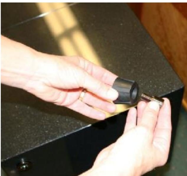
3、将螺栓适配器插入橡胶套座中；
