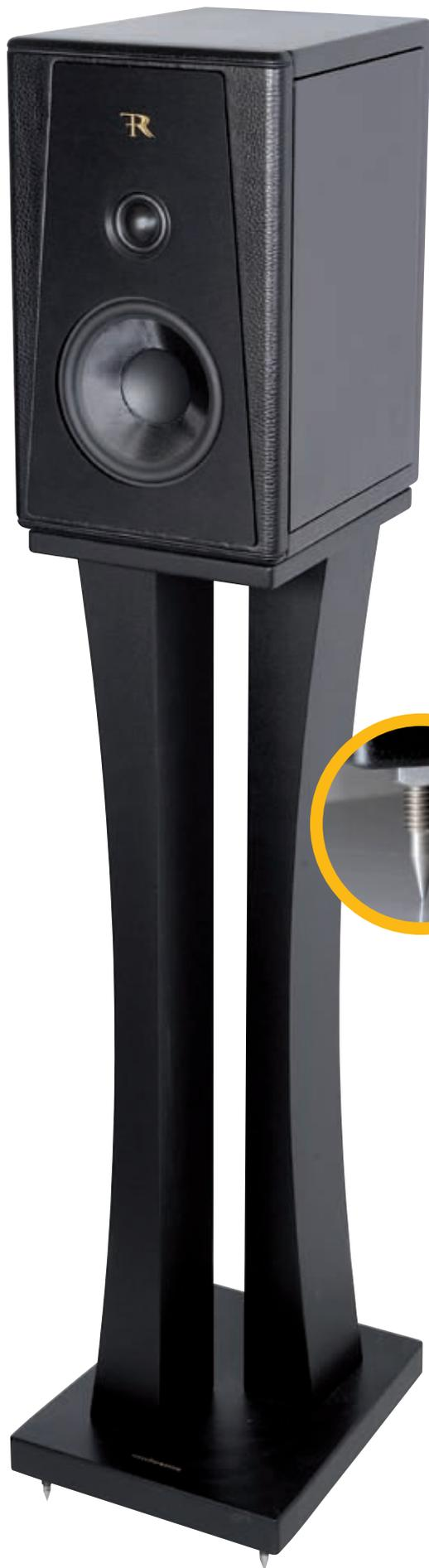
素材的承放頂板，附設四組 M8 螺絲牙的底板與及兩條充滿現代建築色彩的弧形支柱，同樣使用 HDF 加工而成，單純以質感和重量而言，每隻重量只有 7kg 的 HDF 腳架也許未及鐵柱和鋼管般堅固實在，不過廠方強調這兩條弧形支柱同樣經過挖空加工，然後加入指定份量的雲石粉末，並配合貫穿整條支柱的精鋼拉力竿及螺絲母將頂板和底板進行鎖定，對於消除音染可謂相得益彰。修飾方面，這對 Pienza 專用腳架同樣先進行噴沙處理，然後噴上一種有助提高剛性的黑色阻尼油漆，為用家締造一氣呵成的視覺效果。
